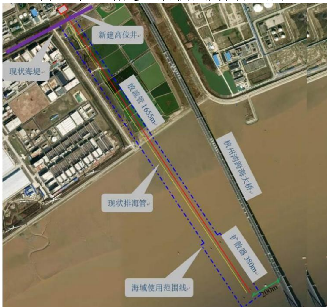
图 3-26 排海管平面示意图
