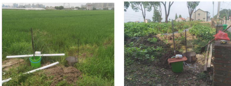
图 5-64 包气带现场渗水试验（ST2、ST3）
